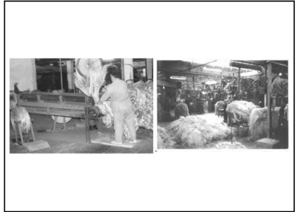
Resim 18: Kenevir lifleri yumuşatılıyor.
