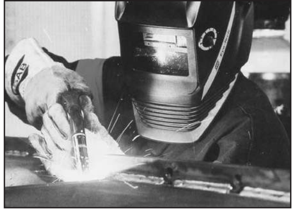
Resim 2: Elektrik kaynağı yapılırken
