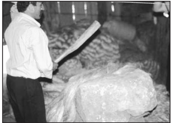
Resim 12: Kenevirler tokmakla yumuşatılıyor.
