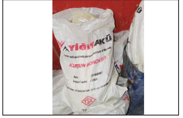
Sayfa 164 Resim 2: Akü yapımında kullanılan kurşun oksit tozu
