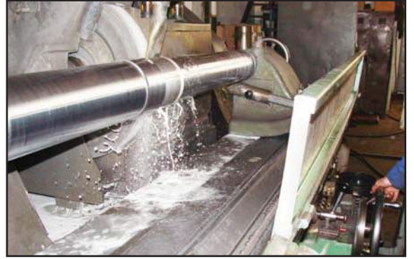
Sayfa 160 Resim 4: Kromajı tamamlanmış malzeme üzerinde kalıntı kirlilikler, zımpara ile siliniyor, parlatılıyor
