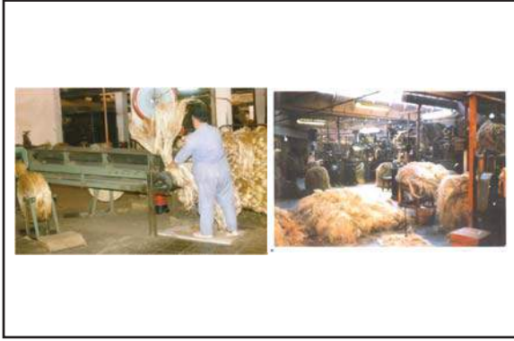
Sayfa 192 Resim 18: Kenevir lifleri yumuşatılıyor.
