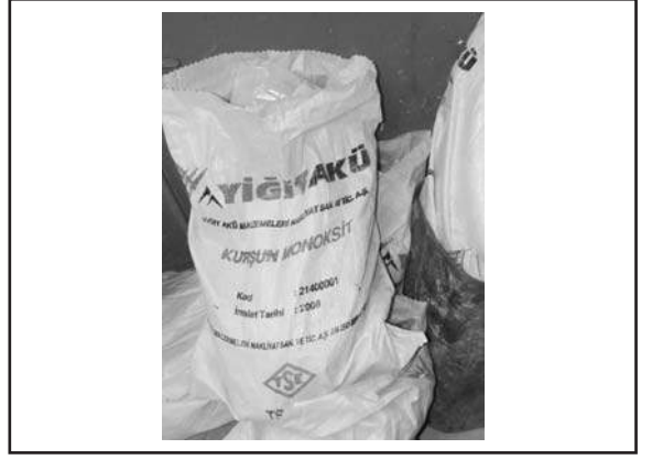
Resim 2: Akü yapımında kullanılan kurşun oksit tozu
