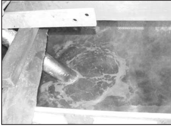
Resim 3: İçinde kromik asit bulunan havuzda demir boru kromaj yapılıyor.
