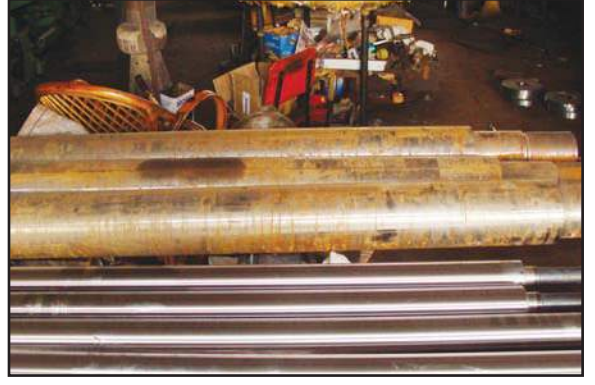
Sayfa 160 Resim 2: Paslı demir borularının kromajdan önce ve sonraki hali.
