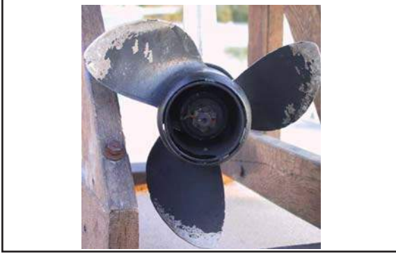
Sayfa 138 Resim 1: Deniz Taşıtlarının pervanelerinin paslanmasını, bozulmasını önlemek için berilyumlu alaşımlardan yararlanılır.
